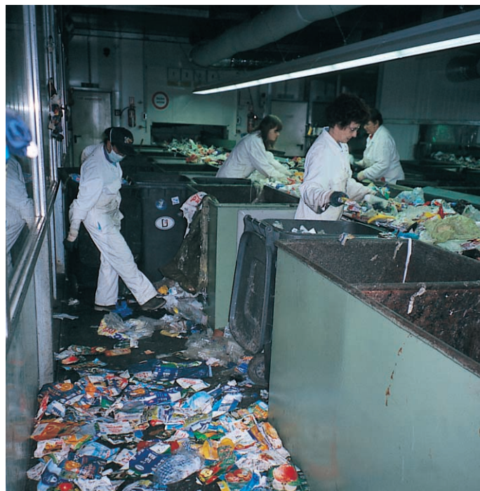
Abb. 1: Sortierkabine einer Wertstoffsortieranlage – starke Verschmutzung durch vom Band gefallene Verpackungsbfälle
